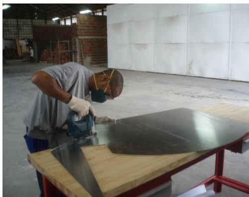
Foto 2: Corte manual de chapas. Fonte: O autor.
