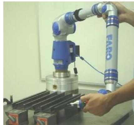
Fig. 3: Medição do modelo reduzido
