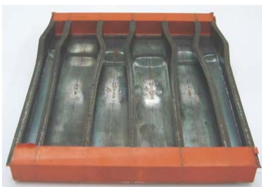
Fig. 6: Pós-colapso – teste experimental
