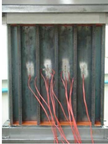
Fig. 4: Posicionamento dos strain-gages no modelo reduzido
