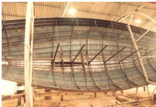
Figura 11 - Dispositivo de fabricação que permite rotacionar a embarcação em 360 graus
