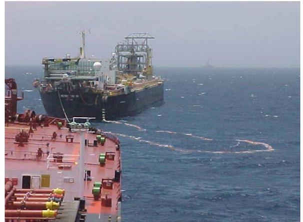
Figura 4: Foto tomada durante uma operação de offloading
