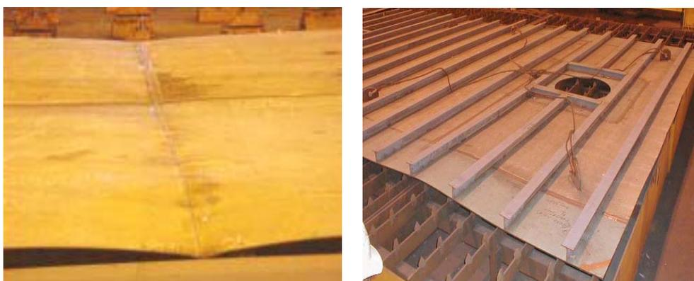
Figura 1: Distorções causadas após processos de soldagem.
