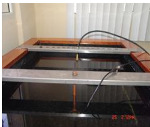
Figura 8. Tanque de experimentación con dispositivos de sujeción de los sensores.
