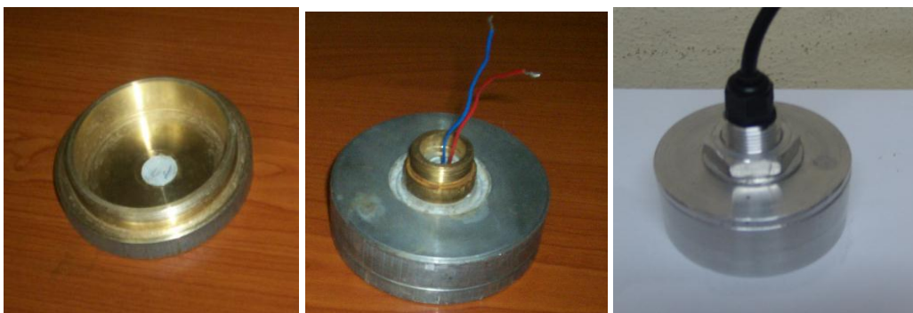
Figura 5. Etapas del montaje y ensamble del sensor acústico flexible piezoeléctrico.
