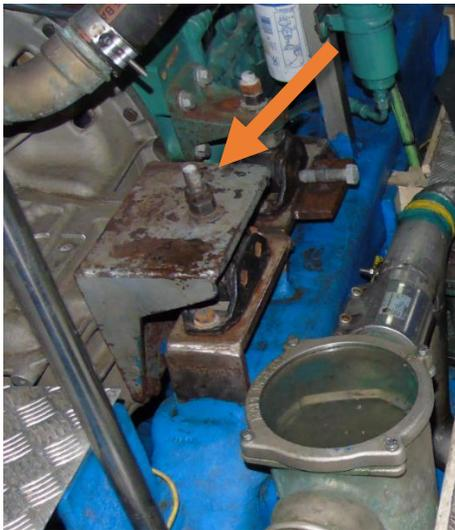
Figura 6. Punto de fijación de la IMU.
