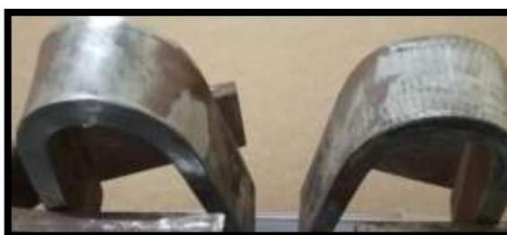
Figura 10. Resultado ensayo de doblado.
