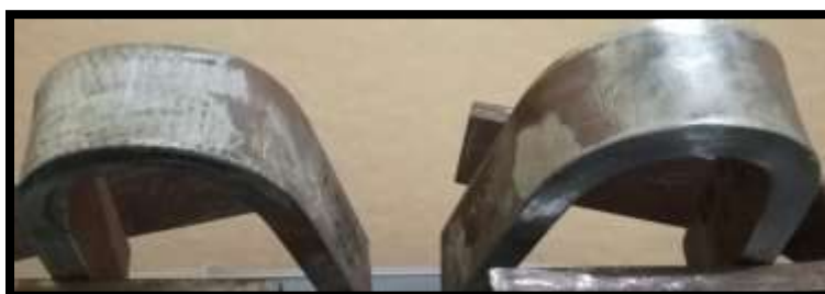
Figura 17. Resultado ensayo de doblado pieza soldada con protección CO 2 .
