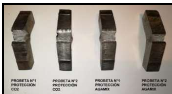
Figura 15. Resulta de ensayo de Charpy a 10 [°C].
