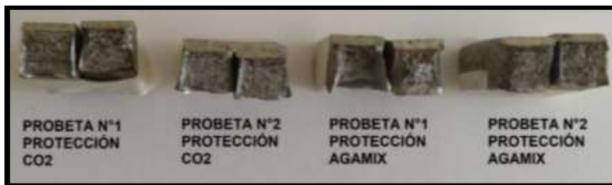
Figura 13. Resulta de ensayo de Charpy a - 10 [°C].
