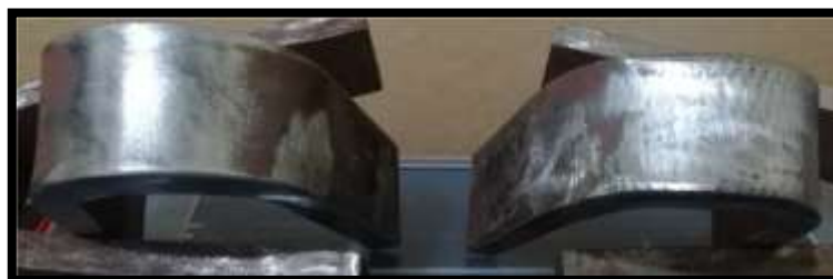
Figura 16. Resultado ensayo de doblado pieza soldada con protección Agamix.
