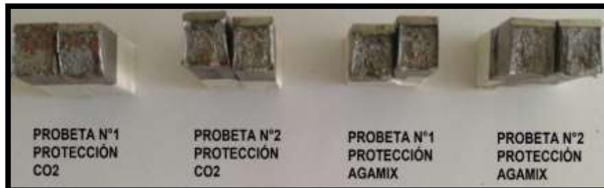
Figura 12. Resulta de ensayo de Charpy a -20 [°C].
