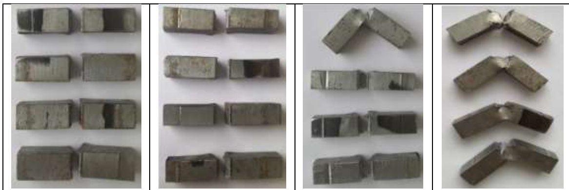
Figura 7. Resultados ensayo de Charpy entre -20 [°C] y 10 [°C].
