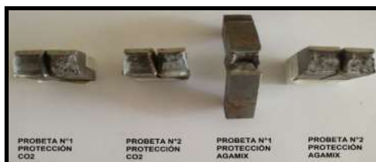
Figura 14. Resulta de ensayo de Charpy a 0 [°C].
