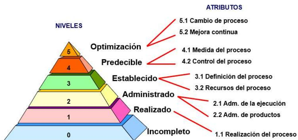
**Figura 1.** Modelo de Capacidades en que se basa la Auditoria Tecnológica (según ISO/IEC 15504-2)
