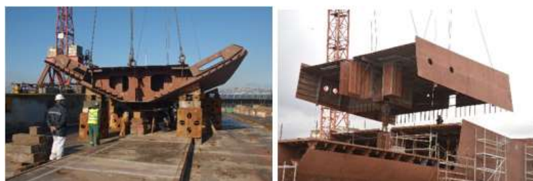
Fig. 34 Montaje de Bloques sin Outfitting
