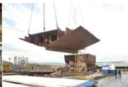
Fig. 16 Montaje Bloque sin Outfitting
