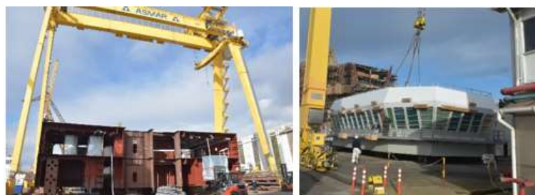
Fig. 34 Montaje de Bloques sin Outfitting
