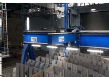
Fig.37 Estación Soldadura Bloques
