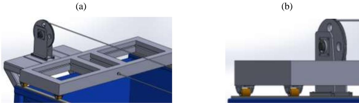
Figura 7. Esquema general del Carro apoyado sobre las dos ruedas de aluminio y banda de poliuretano, además de sus respectivas horquillas fijas. (a) Esquema general, vista isométrica. (b) Ruedas de apoyo del Carro. Elaboración propia.
