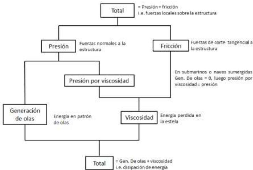
Figura 1. Componentes de la Resistencia del Casco. [1]
