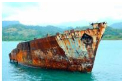
Fig 3. Corrosión del casco
